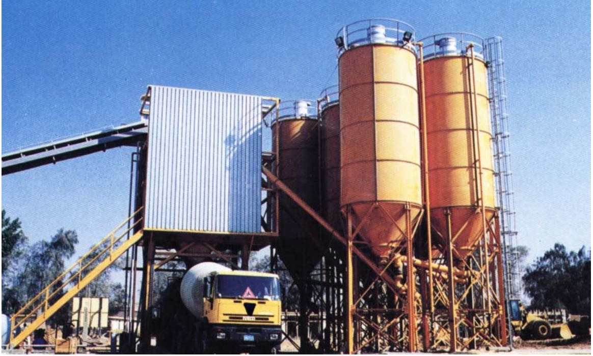
شكل (٤-١) محطة خلط مركزية لإنتاج الخرسانة.
