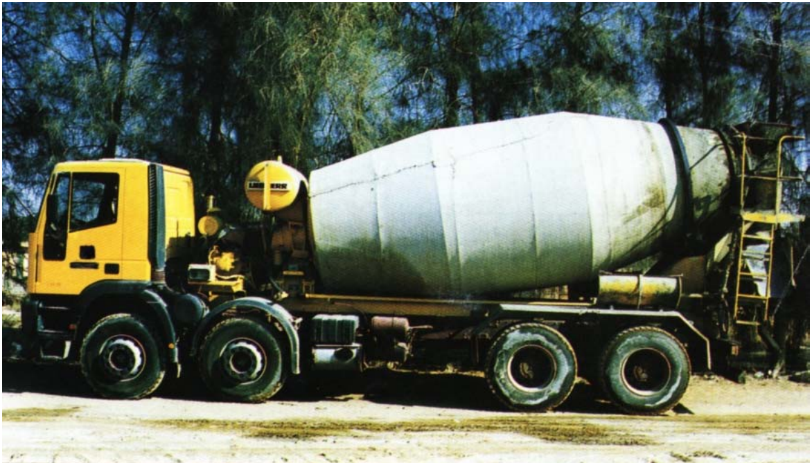
شكل (٤-٢) عربة خلط خرسانة سعة ١٠ متر مكعب.
