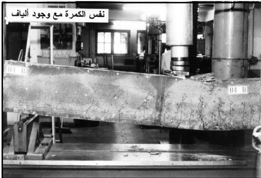
شكل (٣-١٧) تأثير الألياف الفعال في مقاومة قوى القص وزيادة المتانة.
