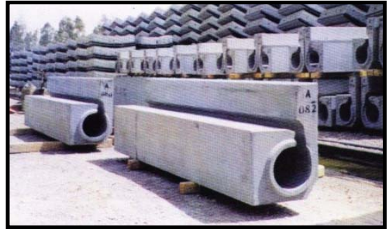
مجارى خرسانية لتصريف مياه الأمطار (نفق الأزهر)
